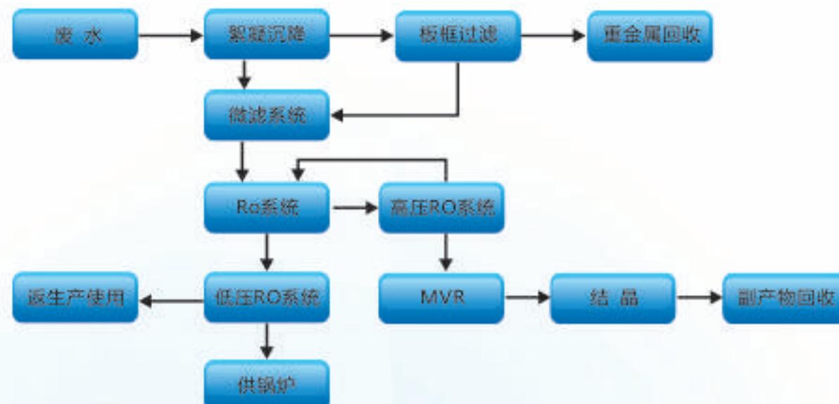
基于对生产系统产生的废水水质特点和回用水质要求，将湿法车间酸性废水、化学水处理站废水、冲洗地面水与污酸处理后的废水排入污水调节池，采用絮凝沉降，再经过组合膜对其进行MVR蒸发结晶，处理后的污水达到生产回用水水质标准。该组合工艺成熟可靠，出水水质稳定，既回收了废水中的有价金属资源，也做到了水资源循环利用。
