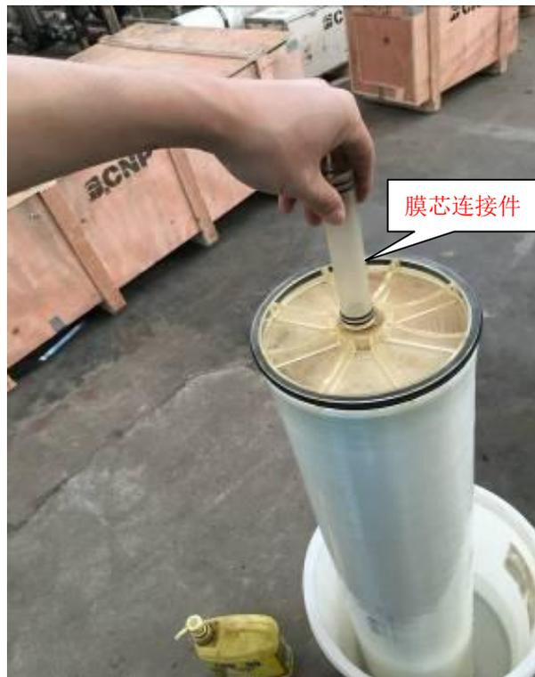
在执行这一过程中一定要注意连接件密封圈不能损坏或跑偏，并且连接件一定要完全插入到中心管中；
