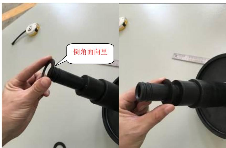
6、最后将进膜端的膜端盖上的半月卡环装上，用内六角扳手锁紧，至此，整根膜管的卷式膜膜芯安装完成；
