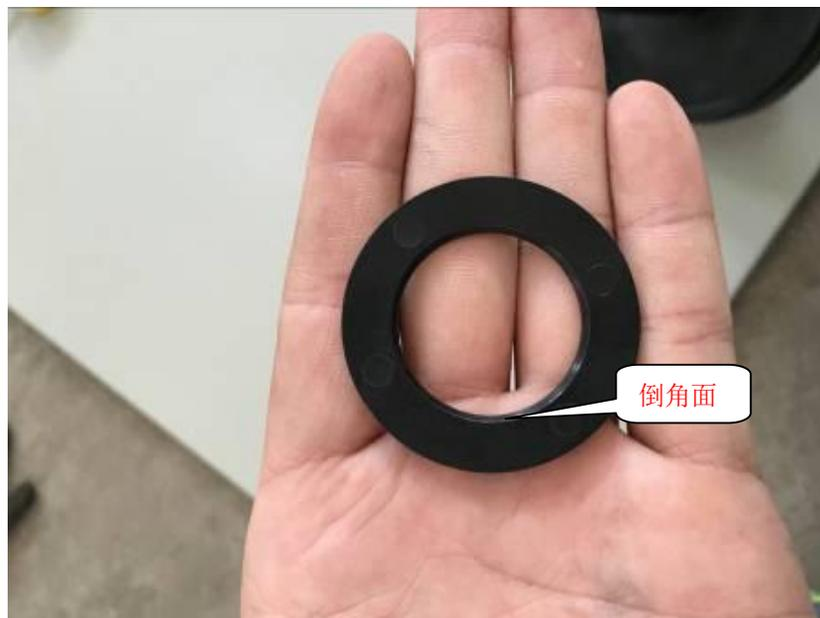
注意：装垫片的时候一定要用润滑剂润滑，此外一定要注意垫片内圈的倒角面，装的时候一定要从倒角面套入端盖的连接件上；
