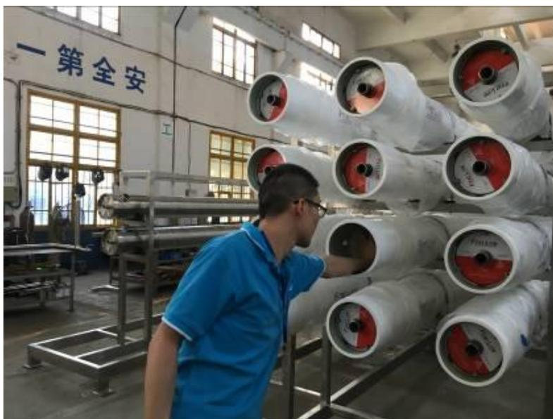
然后用卷尺测量膜芯到半月卡环卡槽内侧的距离，然后再测量一下端盖面到膜芯连接件底部的距离，如下图所示：
