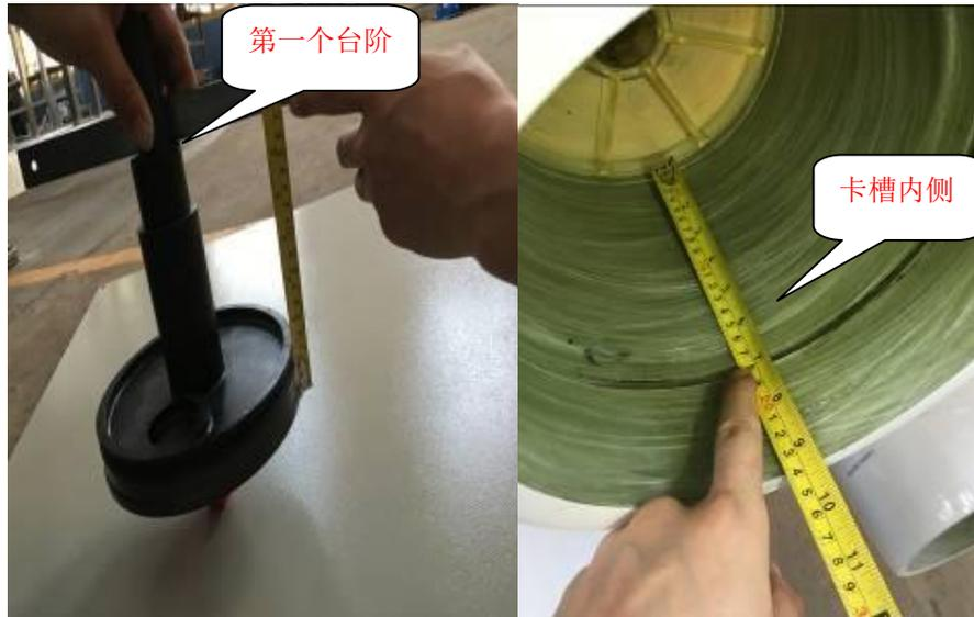
比较两个距离差，如果距离差在三毫米以内，可以直接将端盖按（3）的方法装入膜管，如果大于三毫米，则需要增加相应数量的垫片，每个垫片厚度为 2 毫米，垫片如下图所示，然后再讲端盖装入膜管；
