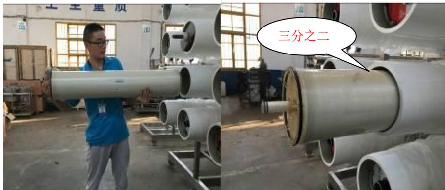
3、用润滑剂均匀涂抹第二根膜芯表面，按照（1）中的步骤插入膜芯连接件，注：如果是两芯的膜管，第二根膜芯不用插膜芯连接件，最后安装的一根膜芯也不需要插膜芯连接件。
